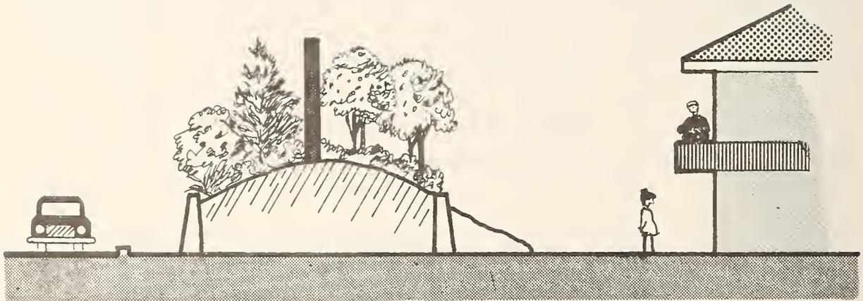
FIGURE 3-28. WALL AND BERM COMBINED TO CREATE MORE HEIGHT IN LIMITED RIGHT-OF-WAY
