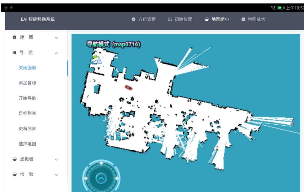
导航模式下，点击“初始位置”，可以在地图上设置一个初始位置（轻按则默认方向，长按可以设置方向），代表底盘所在位置。然后可以展开“检验”，点击“显示激光”，看激光是否与地图轮廓相匹配，如果不匹配，原地旋转底盘 1~3 圈，校正位置（如果无法校正，则是初始位置设置相差太远，需要重新设置）。
