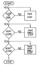
Fig. 7. Subalgorithm STRAIGHT.
