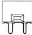
Oriented Med 2-Pin GY9.5 (2.4/3.2mm OD) G29.5
