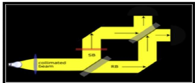
Fig.1.1 Mach-Zehnder Interferometer
