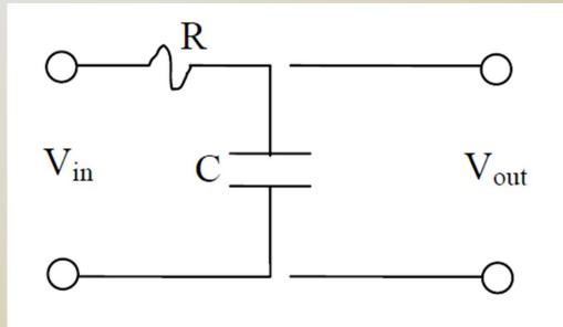
Fig. 1. The RC Circuit.
