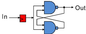
Fig. 8. Prop. mtd (2-A): RS latch circuit
