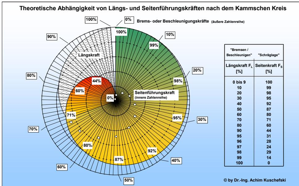
**Abbildung 6: Theoretische Abhängigkeit von Längs- und Seitenführungskräften, errechnet nach der Mittelpunktsleichung des Kreises**
