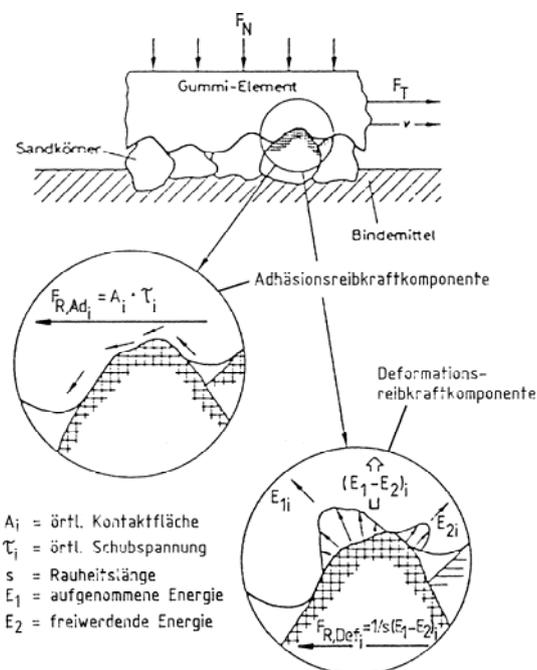
**Abbildung 3: Schematische Darstellung der Adhäsions- und Deformationsreibungskomponente /2/**
