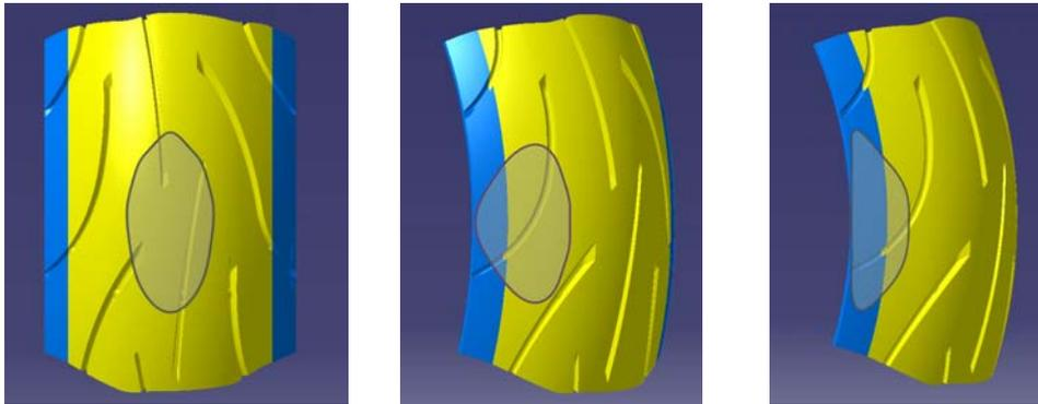
**Abbildung 1: Kontaktfläche (Latsch) eines Motorradreifens bei 0°, 36° und 48° Schräglage /1/**
