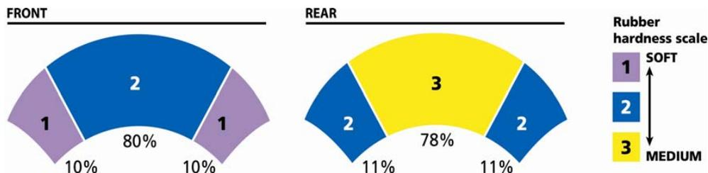
**Abbildung 8: Reifenlauffläche mit zwei unterschiedlich weichen Mischungen /1/**
