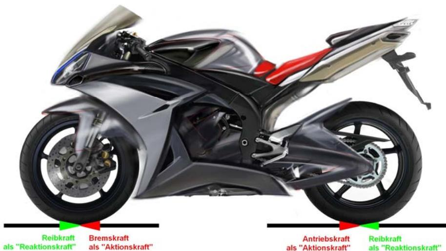
**Abbildung 2: Reibkräfte als Reaktionskräfte aufgrund von Aktionskräften**
