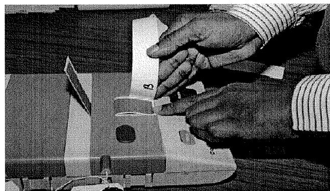
**चौथा कदम.—'B'** को ग्रीन पेपर सील पर चिपकाने पर 'C' ऊपर की तरफ आ जायेगा। 'C' का वेक्स पेपर खोलकर ऊपरी भाग से मशीन को ग्रीन पेपर सील पर चिपका कर सील करें। 'C' के ऊपर का वेक्स पेपर हटा दें, ग्रीन पेपर सील को ऐसे चिपकाए कि वह बाहरी दरवाजे के बाहरी भाग तक चली जाए ताकि हरी पेपर सील 'C' पर पूर्णतः चिपक जाए (अब हरी सील का सफेद भाग ऊपर की ओर जाएगा तथा बाहर से दिखाई पड़ेगा)।
