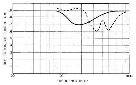
SOLID LINE - 1/8" PLYWOOD DOTTED LINE - 1/16" PLYWOOD
