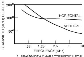
A. BEAMWIDTH CHARACTERISTICS FOR A TYPICAL RADIAL HORN
