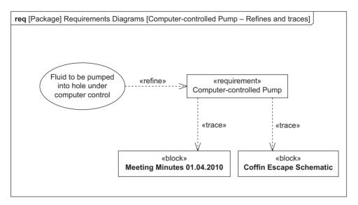
Figure 5.58 Example requirement diagram showing «refine» and «trace» relationships
