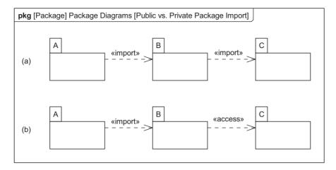
Figure 5.38 Importing packages using «import» and «access»
